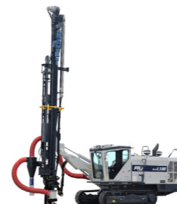
ダウンザホールドリル
