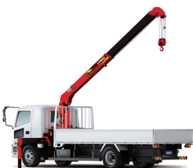
ユニッククレーン
