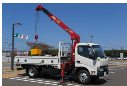
ユニッククレーン
