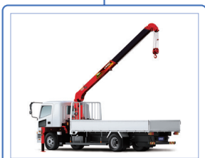
ユニッククレーン
