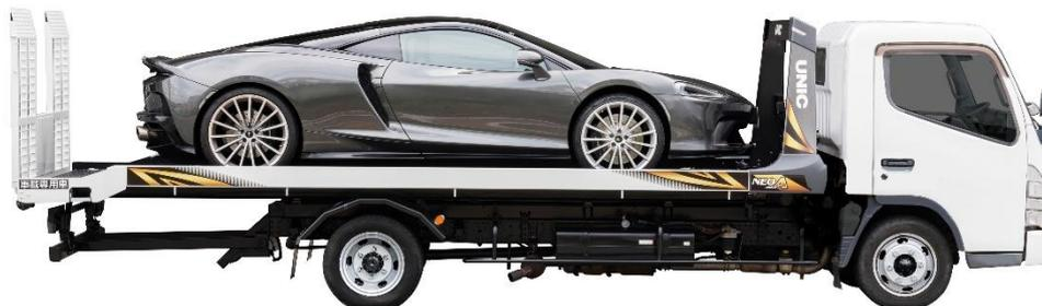
車体の軽量化により積載量が従来機より約 250kg アップ
