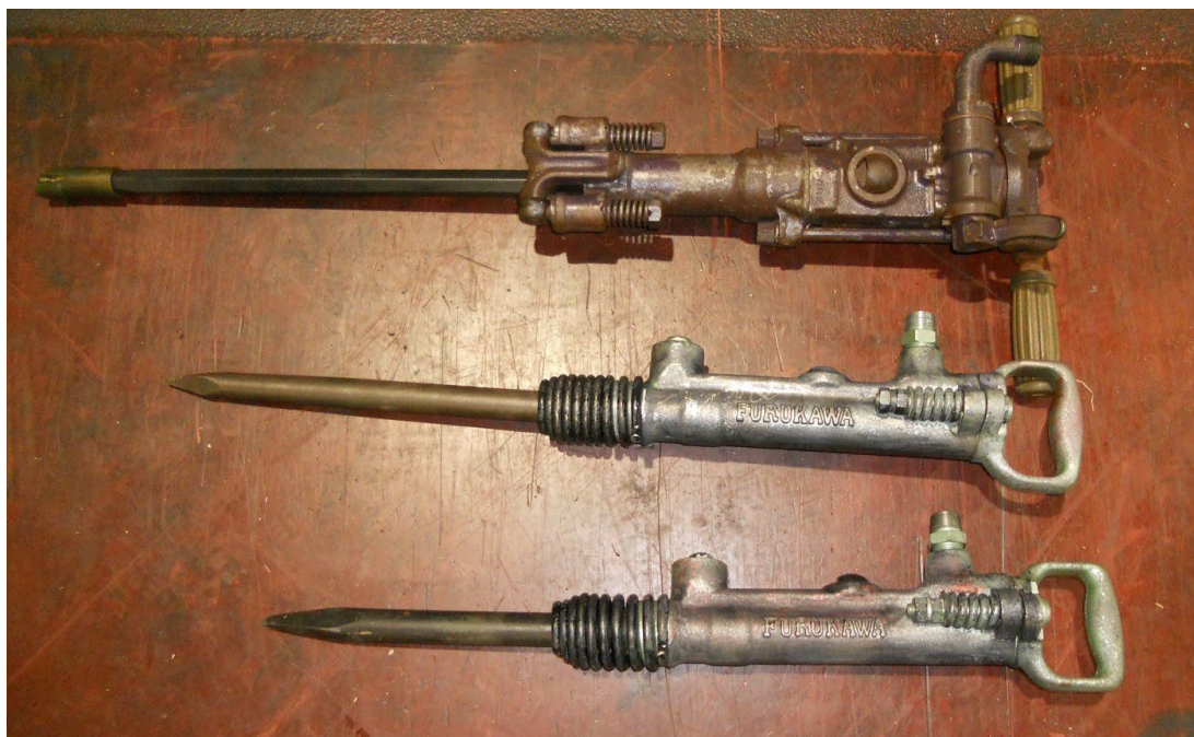
貸し出した手持ち式さく岩機
