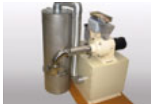
気流式超微粉末製造機「ドリームミル」シリーズの小型機「DM-150S」
