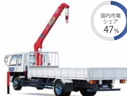
車輻搭載型クレーン (ユニッククレーン)
