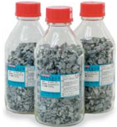
携帯電話等の電子デバイス、赤色のレーザーダイオードやLEDに使用されるガリウムヒ素半導体の材料
