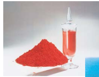
亜酸化銅は船底塗料の防汚剤として使用される赤色の粉末顔料
