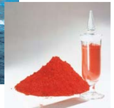
亜酸化銅は船底塗料の防汚剤として使用される赤色の粉末顔料
