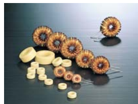
電源や車の電子制御装置などに使用されているコア・コイル
