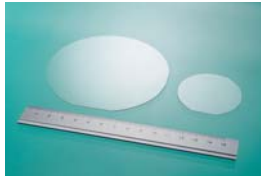
2インチGaN基板と開発した4インチGaN基板
