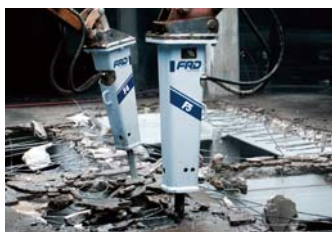
油圧ショベルに装着する油圧ブレードは岩盤破碎、コンクリート破碎等で高い実績があります。
