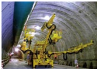
道路や鉄道の山岳トンネル工事で使用され、国内では圧倒的な実績があるトンネルドリルシャンプ
