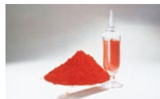
船底塗料の防汚剤として使用される赤色の粉末顔料である亜酸化銅
