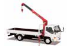
わが国で、車両搭載型クレーンの代名詞となっている「ユニック」
