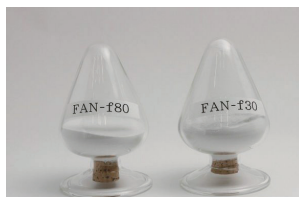
熱伝導性、熱放射特性、電気絶縁性などに優れ、半導体製造装置用部品や基板用材料となる窒化アルミ
