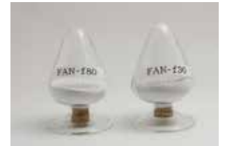
熱伝導性、熱放射性、電気絶縁性に優れ、半導体製造装置用部品や基板用材料となる窒化アルミニウム
