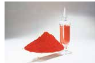
船底塗料の防汚剤として使用される赤色の粉末顔料である亜酸化銅
