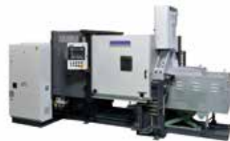
株式会社ヒシヌママシナリーと共同開発したアルミホットチャンバーダイカストマシン
