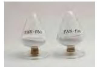
熱伝導性、熱放射特性、電気絶縁性に優れ、半導体製造装置用部品や基板用材料となる窒化アルミニウム
