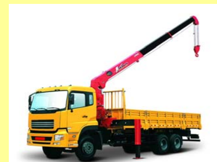
泰安古河製のユニッククレーン(4段ブーム)
