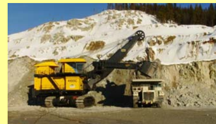
発破原石を切羽から破碎設備まで 大型建機で運搬
