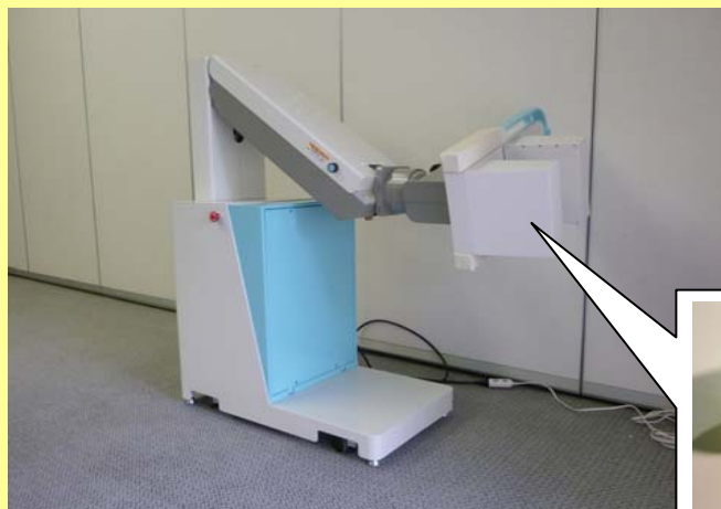
LuAG結晶とPEM装置(試作2号機)
