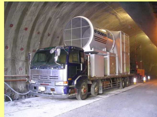
トンネル工事用電気集じん器(e'-DUSCO240)
