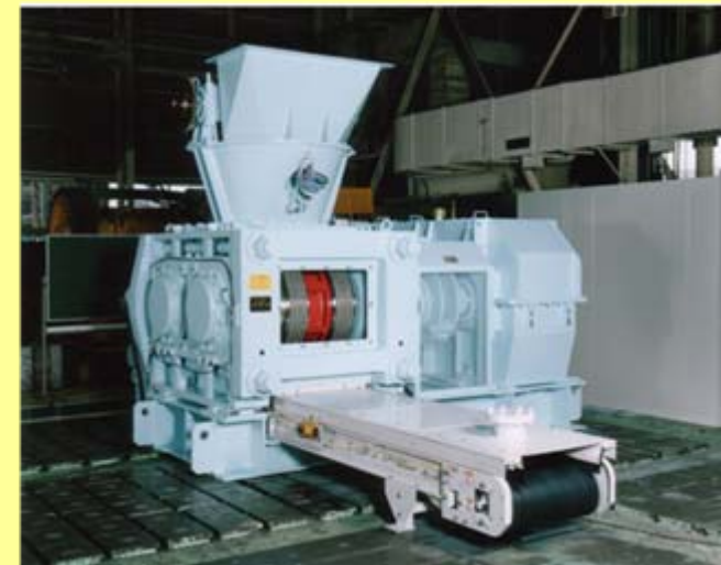
改質炭造粒機 (ブリケッティングマシン)
