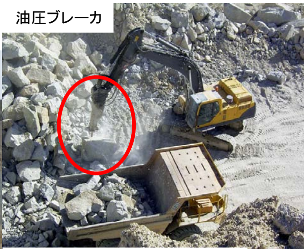
<発破後の大きな岩を小割する機械>
