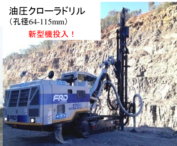
<火薬装填用の穴を開ける機械>
