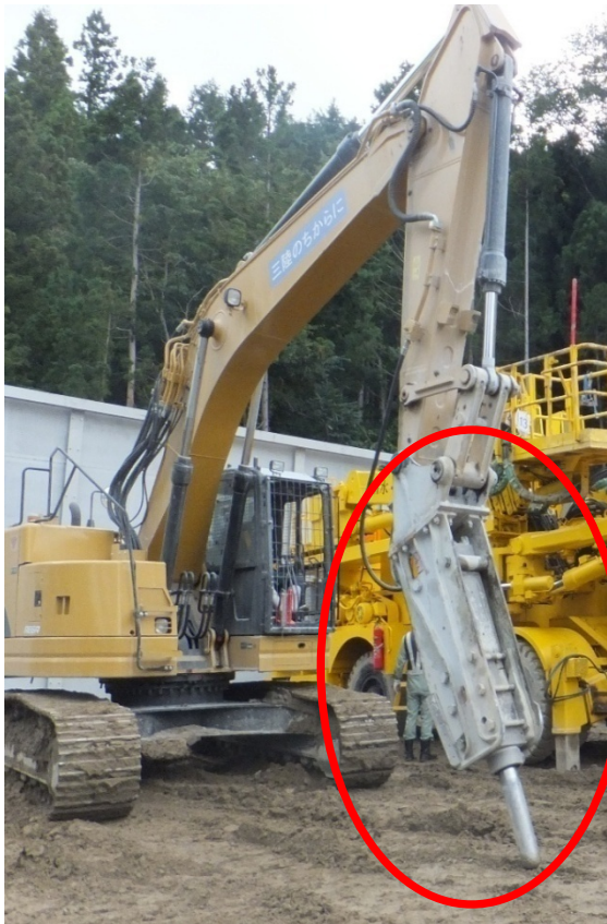
トンネル工事用油圧ブレーカ： 岩盤掘削や発破後の浮石除去に使用
