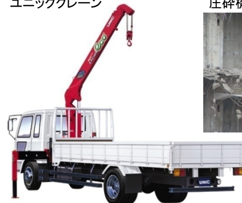
ユニッククレーン
