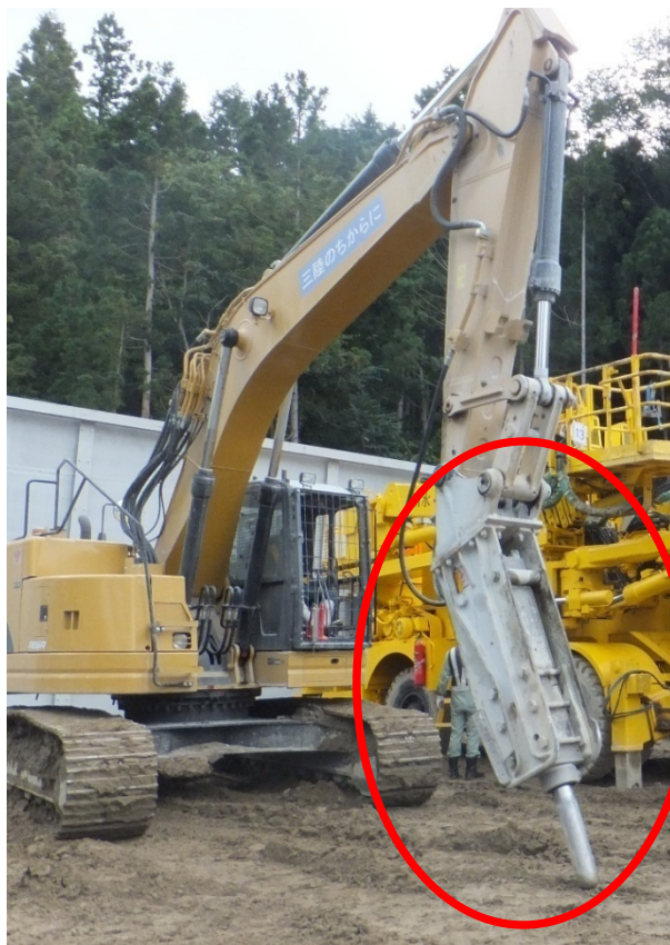
トンネル工専用油圧ブレーカ： 岩盤掘削や発破後の浮石除去に使用
