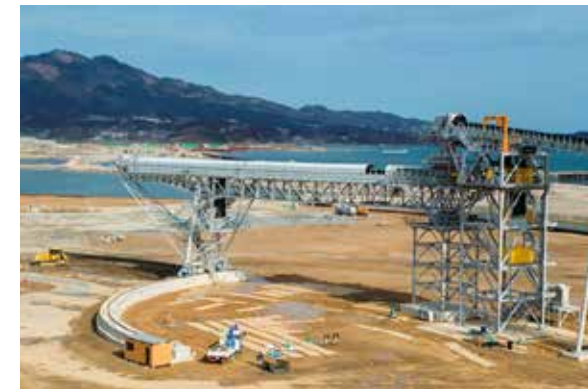
旋回コンベア:先端が半円状に動くため、 大量の土砂を仮置きできる
