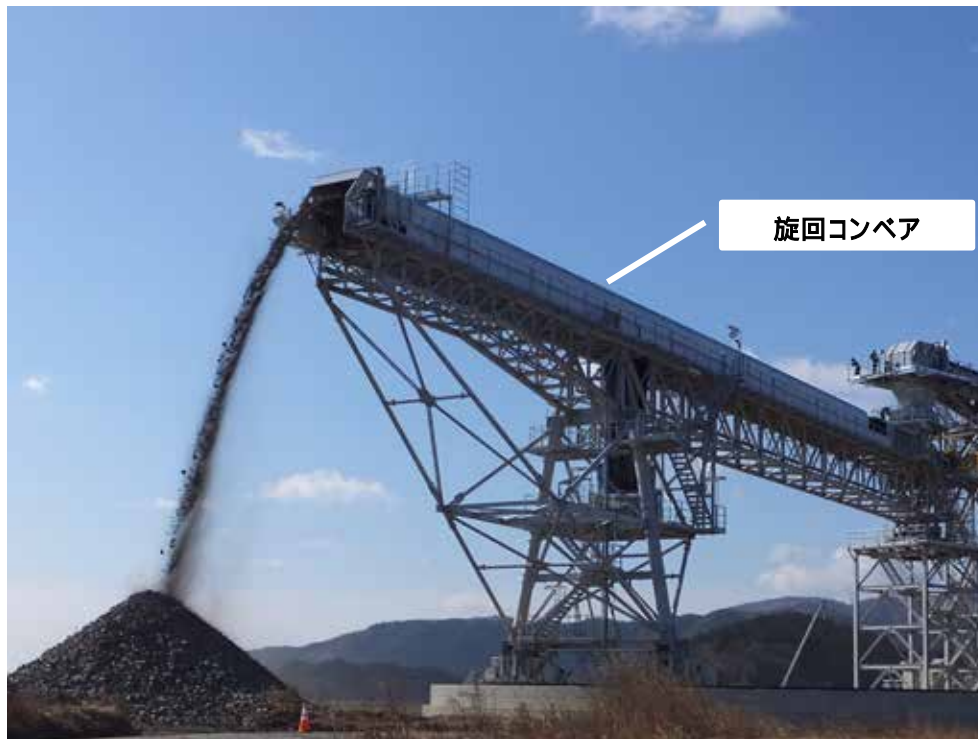
旋回コンベア:先端が半円状に動くため、 大量の土砂を仮置きできる
