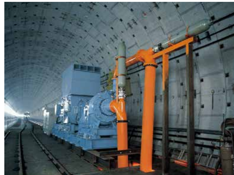
シールドポンプ： 削った土砂を水と一緒に排出するポンプ
