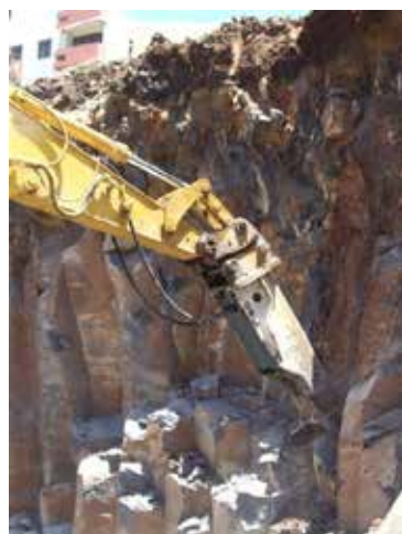
鉄鉱石・銅鉱石・石炭・石灰石など各種鉱山や碎石現場では、発破用の穴を掘る油圧クロードリルや大きな岩石を破砕する油圧ブレーカが活躍
