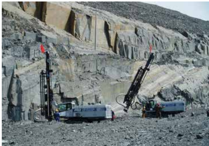
鉄鉱石・銅鉱石・石炭・石灰石など各種鉱山や碎石現場では、発破用の穴を掘る油圧クロードリルや大きな岩石を破砕する油圧ブレーカが活躍
