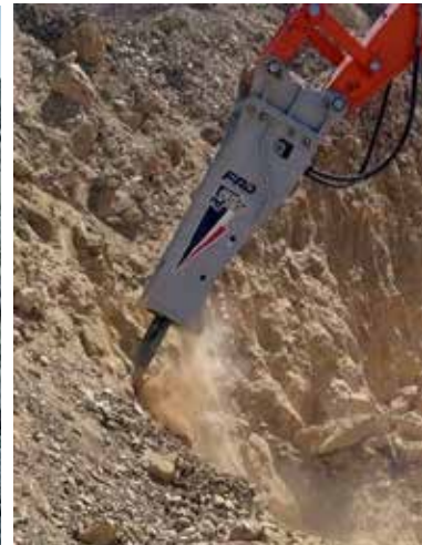
鉄鉱石・銅鉱石・石炭・石灰石など各種鉱山や碎石現場では、発破用の穴を掘る油圧クロードリルや大きな岩石を破砕する油圧ブレーカが活躍
