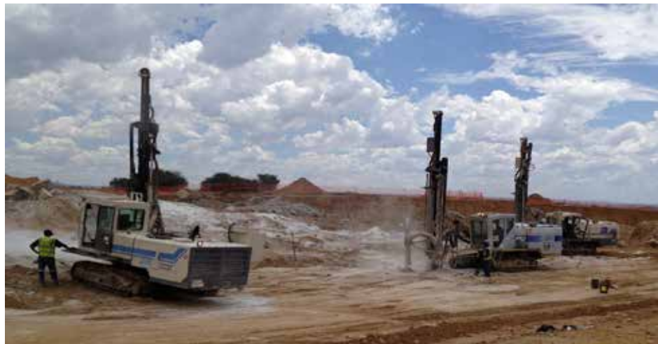
鉄鉱石・銅鉱石・石炭・石灰石など各種鉱山や碎石現場では、発破用の穴を掘る油圧クロードリルや大きな岩石を破砕する油圧ブレーカが活躍
