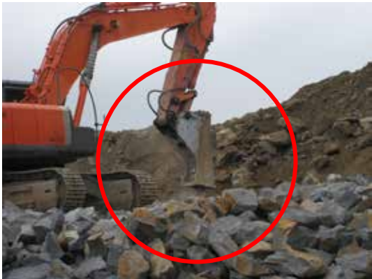
油圧ブレーカ： 発破後の大きな岩石を小割する 油圧ショベルのアタッチメント製品
