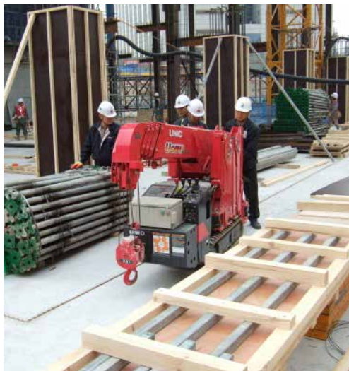
コンパクトで自走可能なミニ・クローラークレーンは、建設現場や屋内の狭いスペースで作業可能なため、欧米を中心に用途開拓が進む
