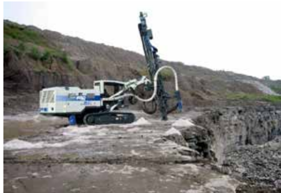
油圧クローラドリル： 岩盤発破に必要な火薬装填用の 穴を開ける機械
