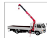
ユニッククレーン
