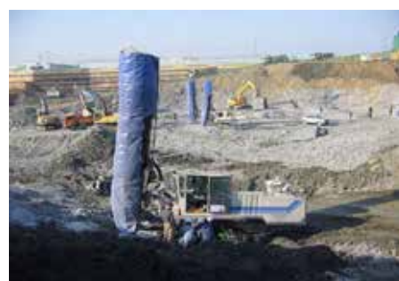
鉄鉱石・銅鉱石・石炭・石灰石など各種鉱山や碎石現場では、発破用の穴を掘る油圧クロードリルや大きな岩石を破砕する油圧ブレーカが活躍
