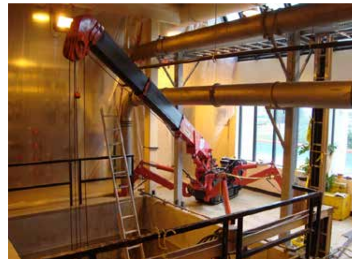
コンパクトで自走可能なミニ・クローラークレーンは、建設現場や屋内の狭いスペースで作業可能なため、欧米を中心に用途開拓が進む
