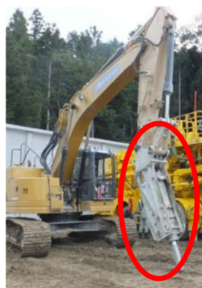
油圧ブレーカ： 岩盤掘削や発破後の 浮石除去に使用
