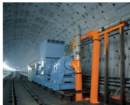
シールドポンプ： 掘削した土砂を水と一緒に排出する ポンプ
