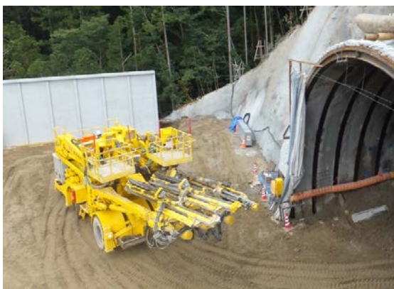
トンネルドリルジャンボ： 岩盤発破に必要な火薬装填用の 穴を開けるロックドリル
