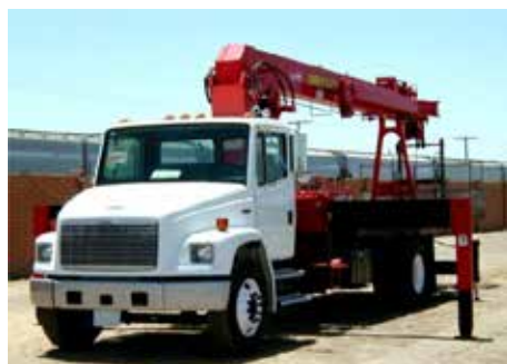
ユニッククレーン
