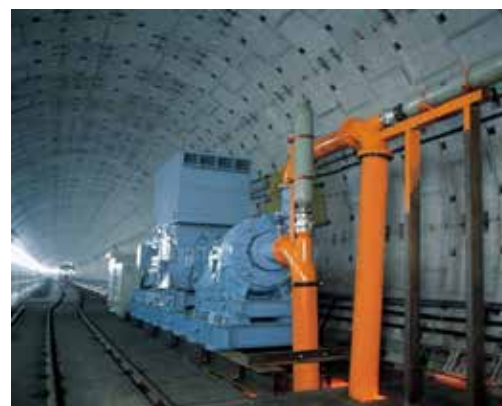
シールドポンプ： 掘削した土砂を水と一緒に排出する ポンプ
