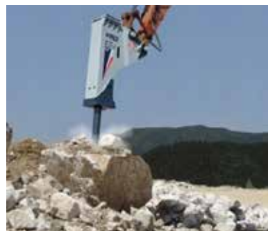
油圧ブレイカ： 発破後の大きな岩石を小割する油圧ショベルのアタッチメント製品
