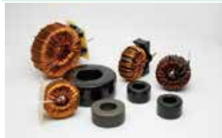
コア・コイル：車の電子制御装置などに使用
