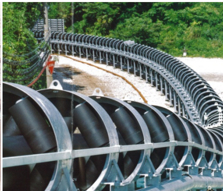
パイプコンベヤ
