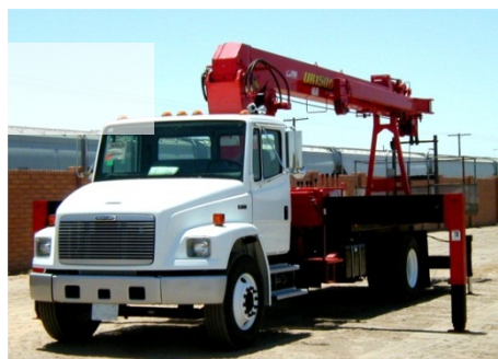
ユニッククレーン
