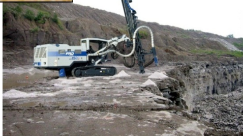
油圧クローラドリル： 岩盤発破に必要な火薬装填用の穴を開ける機械
