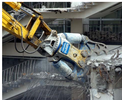
油圧圧砕機： コンクリートの解体に使用する 油圧ショベルのアタッチメント製品
