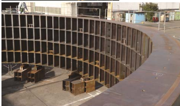
トンネル工事のシールド工法で 使用される鋼製セグメント
