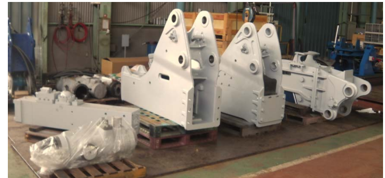
リビルドした油圧ブレーカ及び油圧圧砕機シリンダ(左)
