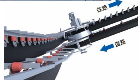
境川金森調整池造成工事(東京都町田市)向け密閉式吊下げ型コンベヤ SICON®は、ContiTech Transportbandsysteme GmbH社の登録商標
