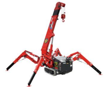
AGMバッテリー仕様のミニ・クローラクレーン
