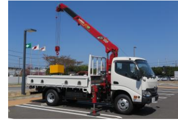
ユニッククレーン
