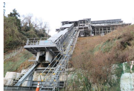
ダム急傾斜実証機 密閉式吊下げ型コンベヤ（SICON®）
