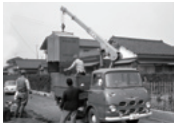
物流と荷役・建設作業を一手に担う 国内初の車両搭載型クレーン「UNIC100」
