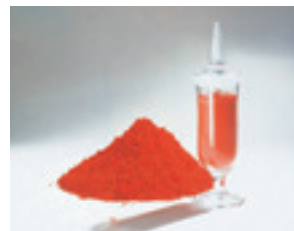
船底塗料用防汚剤に使用される亜酸化銅
