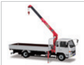
ユニッククレーン
