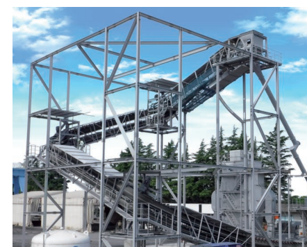
スパイラル式パーチカルコンベヤの実証試験設備
