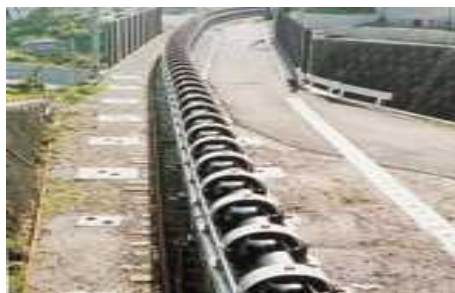
パイプ状の密閉構造方式で輸送するため、急傾斜搬送が可能な他、曲送など直線構造に限定しない設置が可能であり、搬送物の落下や飛散が少ない等、環境に対応したコンベヤ
