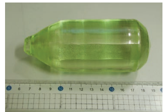
引上法による2インチ径結晶
