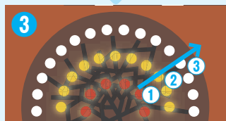
3 仕込んだ火薬をトンネルの中心部から時間差で爆破させて岩盤を崩します。
