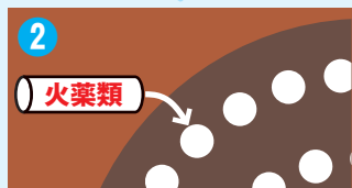
2 火薬類 穴に火薬類を仕込みます。
