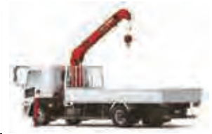
ユニッククレーン トラックに搭載されたクレーン。建設現場などで活躍しています。
