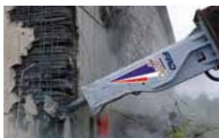
■油圧ブレイカ 岩石の小割りやコンクリートの破砕に使用されています。
