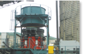
■破砕機 砕石場などで岩石を細かく破砕する機械です。
