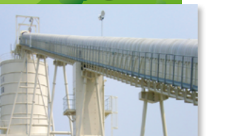
■ベルトコンベヤ 大量の土砂や鉱石、石炭などの原料を運搬する装置です。
