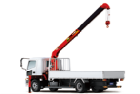
■ユニッククレーン トラックに搭載されたクレーン。建設現場などで活躍しています。
