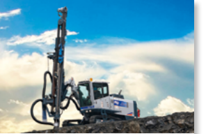
■油圧クローラードリル 砕石場や石灰石鉱山で発破用の孔(あな)を掘る機械です。
