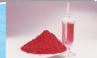
■亜酸化銅 環境配慮型素材として船底塗料に使用されています。
